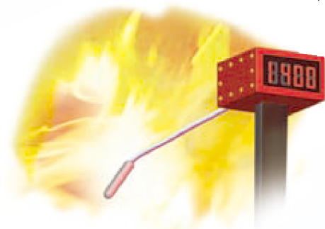
图3.1-6 热电偶温度计
