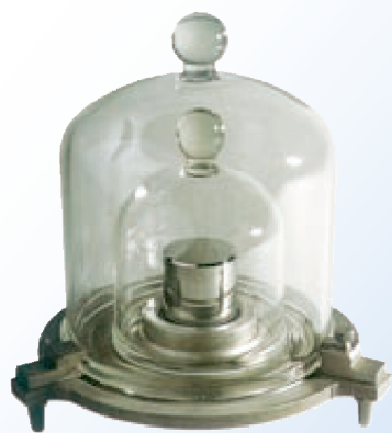
图6.1-5 国际千克原器（复制品）
