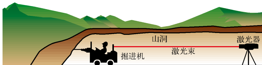
图4.1-4 激光引导掘进方向
