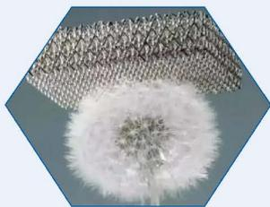
图 6.4-4 微晶格材料
