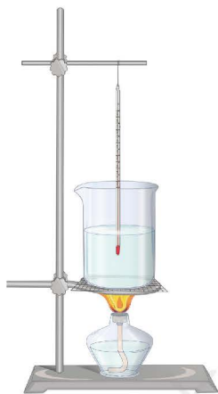
图 1.3-5 探究水沸腾的实验装置
