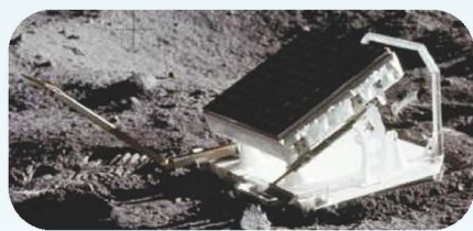
图 4.2-12 安装在月球上的角反射器
