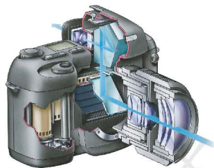
图 5.3-6 单反相机剖面图
