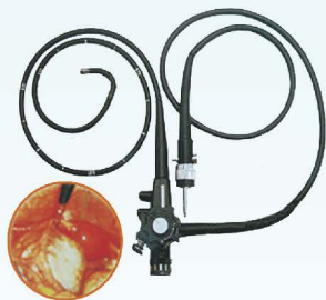
图 4.4-15 光导纤维可以做成 直径只有 0.5 cm 的胃镜
