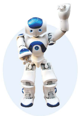
图 3.4-6 可利用语音控制的机器人
