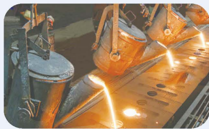
图 1.2-1 铸造金属零件
