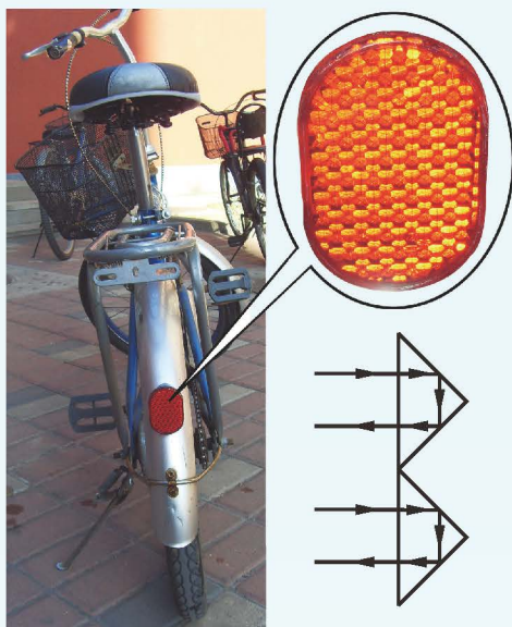
图 4.2-10 自行车上的角反射器及其构造
