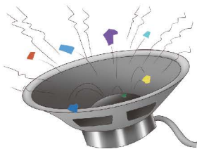
图 3.2-5 纸屑在发声的喇叭上跳动起来
