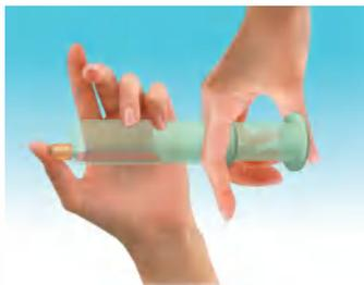
图2-20 乙醚的汽化与液化
