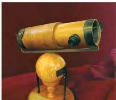
图4-32 牛顿制造的反射式望远镜
