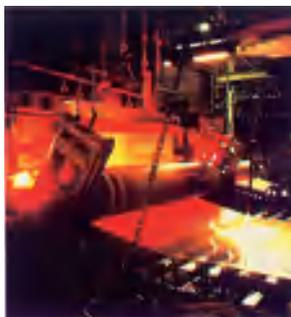
图 2-35 将熔融状态的玻璃轧制成玻璃板
