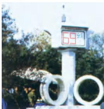
图0-18 设置在街头的噪声监测仪
