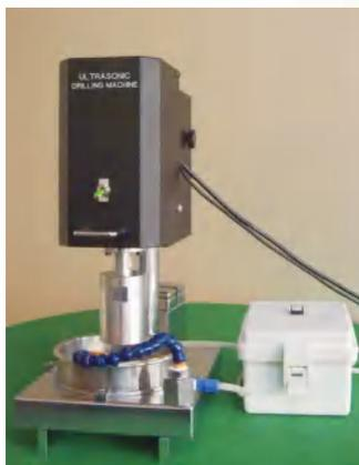
图 1-10 超声波钻孔机
