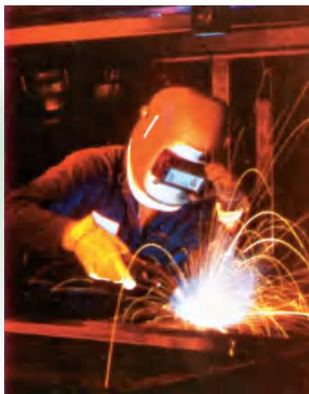
(a) 工人在焊接时戴上防紫外线的面罩
