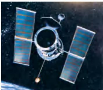
图3-11 哈勃空间望远镜上的太阳能电池板
