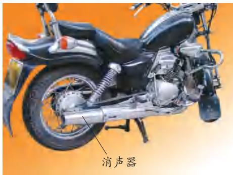
(a) 在摩托车发动机上安装消声器
