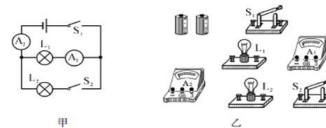
20. 如图所示, 闭合开关, 电流表 A1 和 A2 指针偏转相同如图乙所示, 电压表示数为 4.5V, 求:
