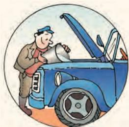
图 13-11 用冷水冷却汽车发动机
