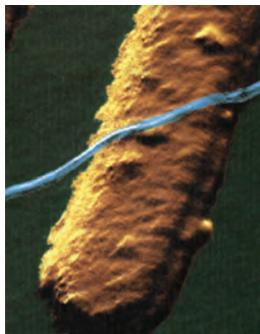
图 20-32 计算机芯片中一种直径为纳米级的导线(蓝色)
