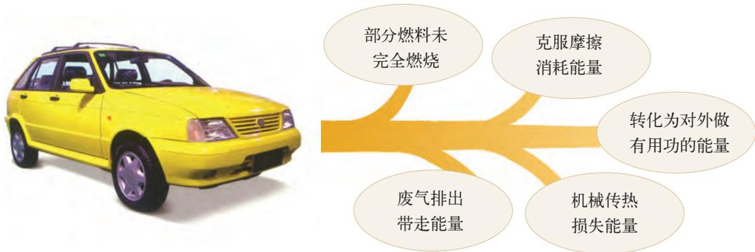
图 13-21 热机燃料的能量走向示意图
