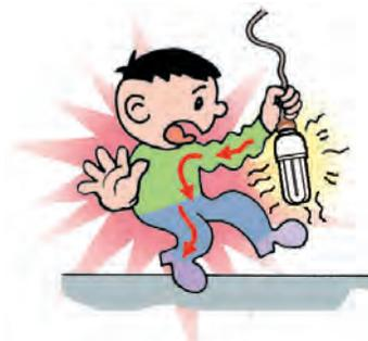
(b) 人触到了破损用电器中的火线，电流流过人体入地，很危险
