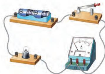
图 14-32 电流表的正确接法
