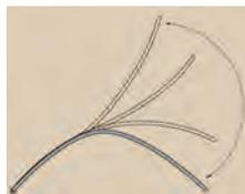
图 13-4 铁丝反复弯折处会发热
