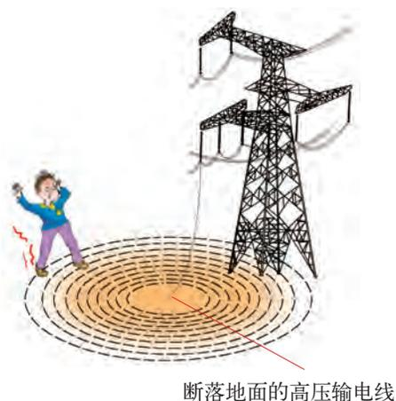
图 18-23 警惕跨步电压的伤害
